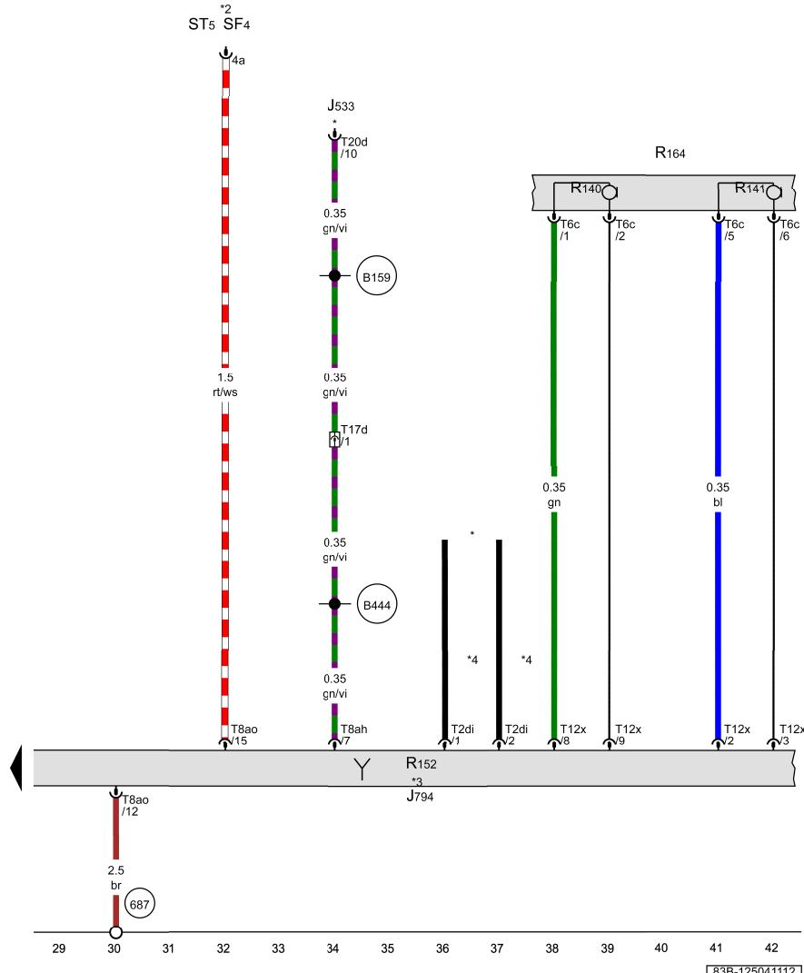
数据总线诊断接口, 电子通讯信息设备 1 控制单元, 蓝牙天线, 前部车顶模块中的麦克风单元
