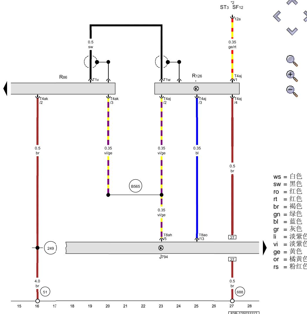
电子通讯信息设备 1 控制单元, 移动电话功率放大器, 电话固定支架
